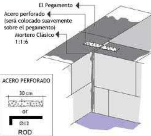
Conexión de las paredes "T" (conexión flexible)
