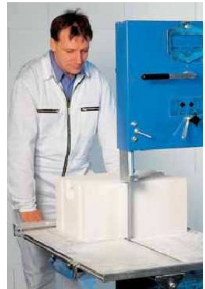
Cortando a medida una pieza de hormigón celular
